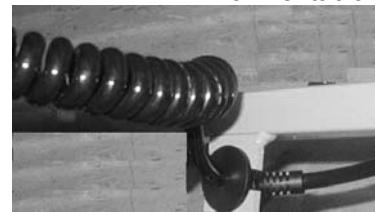
Figura 15: Compensación de tracción cable para la alimentación
