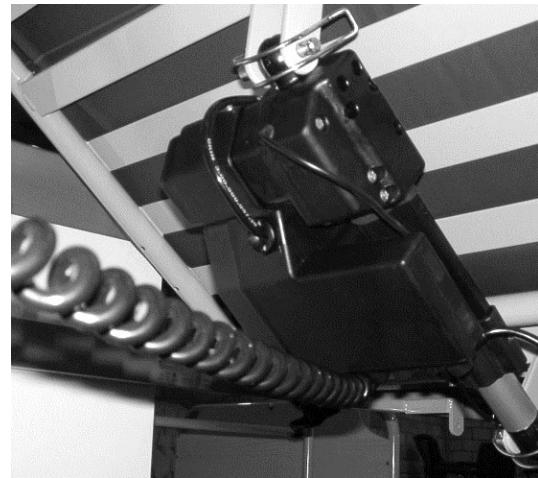
Afb. 14: Aanleg van de kabel voor de netaansluiting
