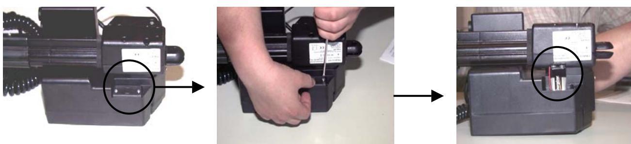
Figure 25: Changement de la pile de secours
