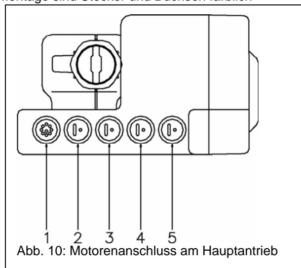
**WICHTIG:** Falsches Anschließen kann irreparable Schäden verursachen. Achten Sie unbedingt auf die korrekte Position der Stecker wie unten abgebildet.
