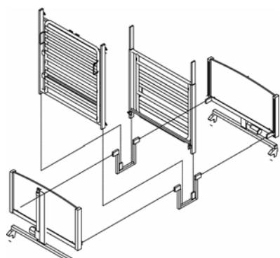
Figure 2: Assemblage sur le kit de transport
