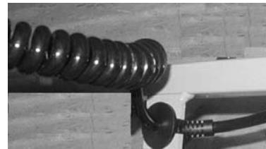
Afb. 15: Trekontlasting van de kabel voor de netaansluiting
