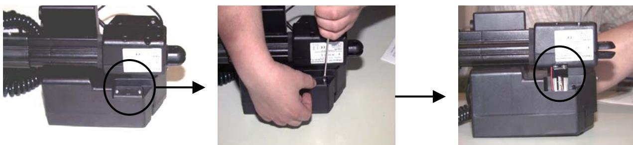
Figura 25: Sustitución de la batería de reserva
