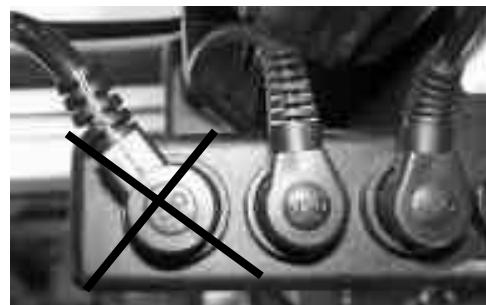
Abb. 11: Richtiger Anschluss von Motoren und Handschalter
