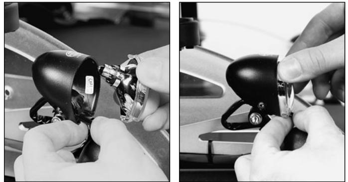
Abb. 41 Halogenlampe Frontbeleuchtung tauschen
