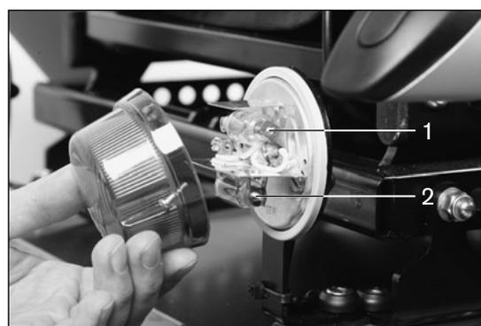
Abb. 43 Heckbeleuchtung demontieren
