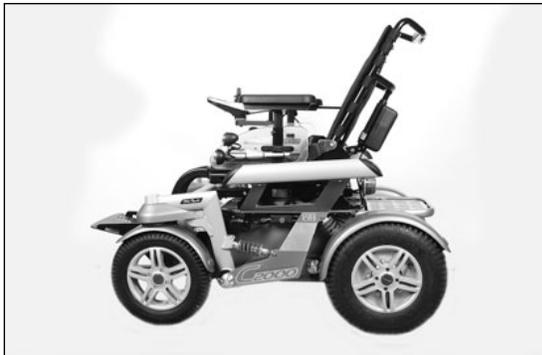
Abb. 26 C2000 mit verstelltem Rückenwinkel
