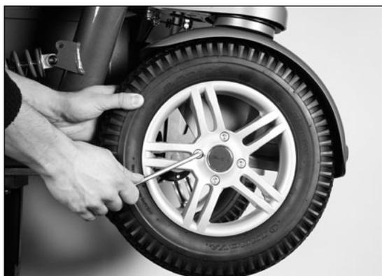
Abb. 38 Lenkrad demontieren
