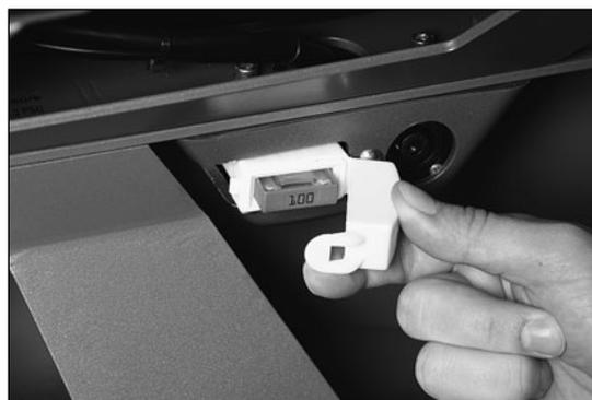
Abb. 37 Sicherung wechseln
