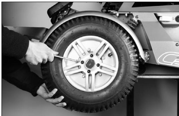
Abb. 39 Antriebsrad demontieren
