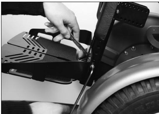
Abb. 13 Fußbrett / Fußrasten an Unterschenkellänge anpassen
