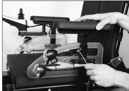
Abb. 10 Armauflage an Oberarmlänge anpassen
