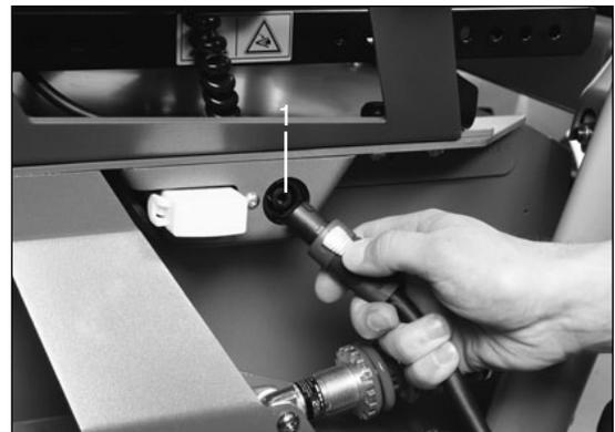
Abb. 22 Ladegerät an Ladebuchse anschließen
