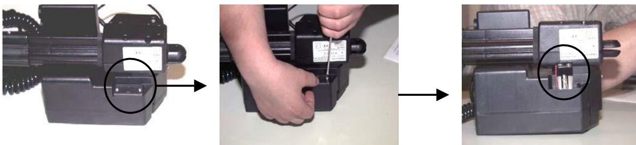
Obr. 25: výměna záložní baterie
